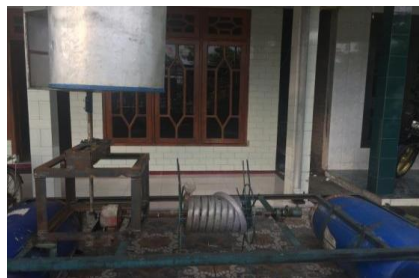
Gambar 4. Aerator Tambak Udang
